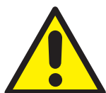
En todas las zonas donde concurren varios riesgos o no exista señalización específica.
